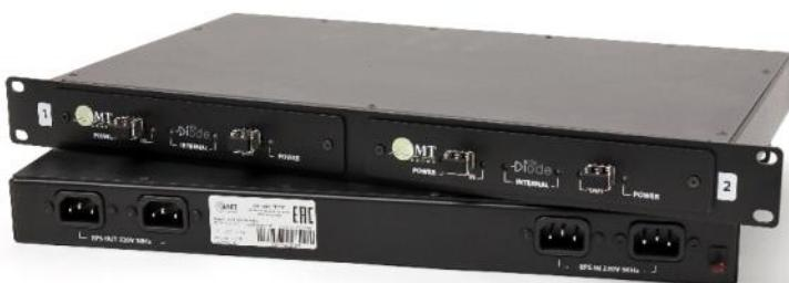
Базовое аппаратное решение для монтажа в стойку (два «диода» в одном). Обеспечивает защиту на аппаратном уровне. Решает задачи по передаче UDP, Syslog, SPAN трафика потребителям за пределами доверенного сегмента, изолируя этот сегмент. Имеет резервирование по электропитанию.
